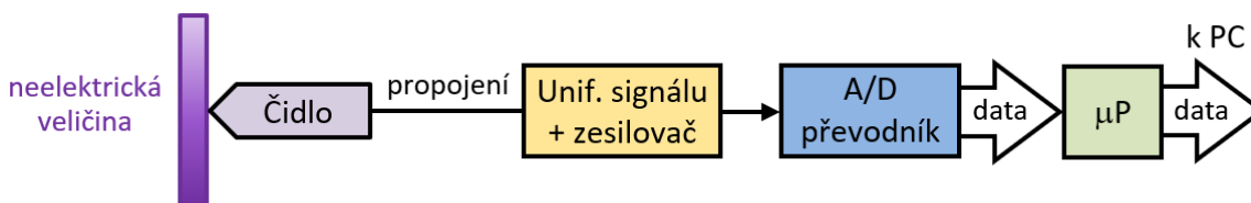
Obr. 13 – Nespojitý řetězec s mikropočítačem, zdroj autor
