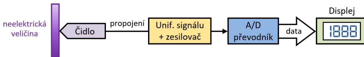
Obr. 12 – Nespojitý (digitální) řetězec bez PC, zdroj autor
