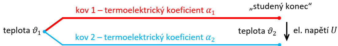
Obr. 16 – Vznik termočlánu, zdroj: autor
